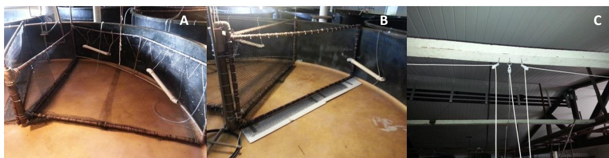
Figura 1. Estrutura armada utilizada para visualização de reprodutores de Litopenaeus vannamei : A) Gaiola móvel; B) Tela móvel destacável; C) Roldanas para suspensão da estrutura completa.
