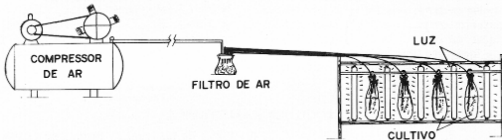
FIGURA 4 – Quadro esquemático do conjunto de compressor de ar, filtro de algodão e cultivos.
