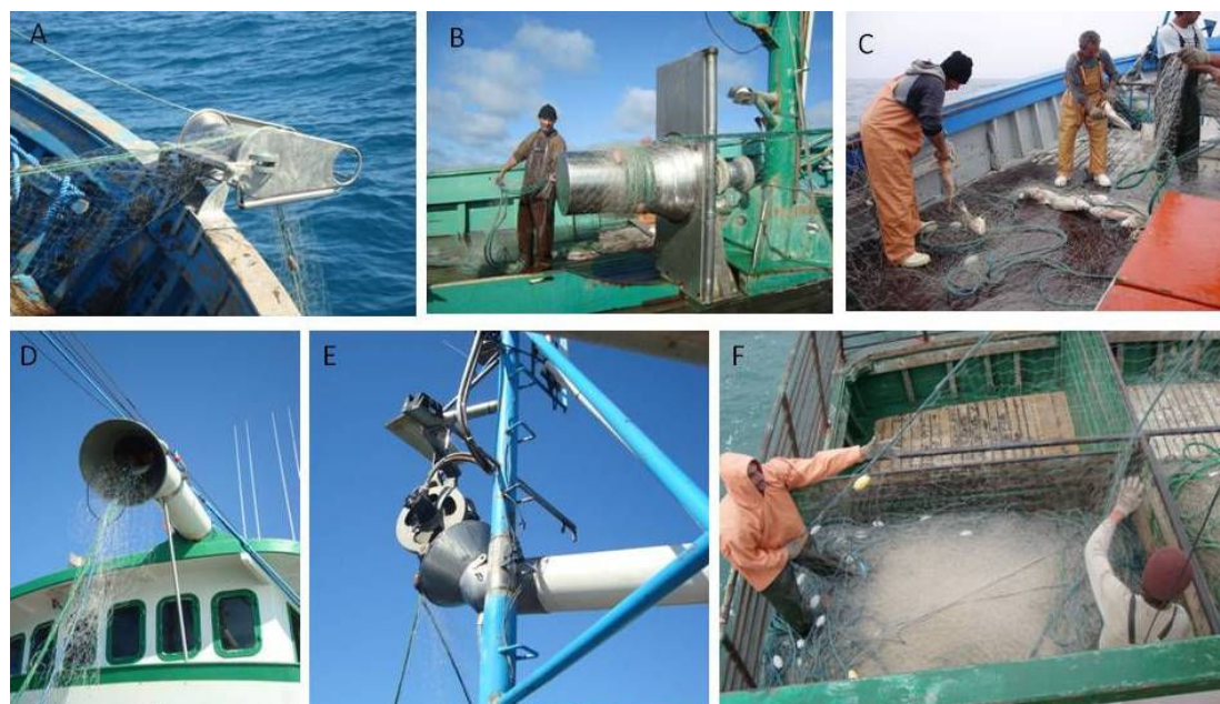
Figura 6. Operação de recolhimento: (A) passagem da rede pelo "carro de borda"; (B) guincho de tração; (C) despesca no convés; (D) passagem da rede pelo tubo de PVC; (E) power-block ; (F) acondicionamento das redes na caixa pelos tripulantes. Fotos: Luciano Cardoso Morais (A, B, D e E), Luís Rodrigo Maçaneiro Leão (C), Christopher Barrutas Currito de Oliveira (F).
